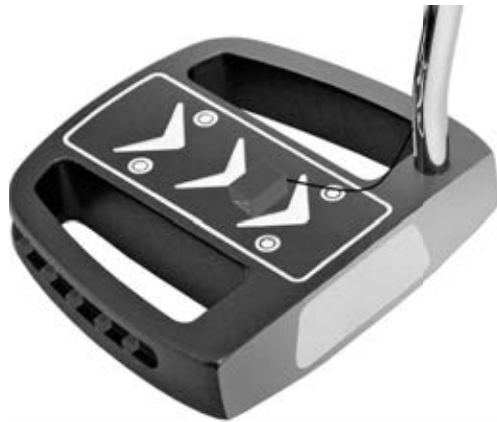
Figura 3. Instalação do acelerómetro e de LEDs na cabeça do putter – imagem adaptada de http://www.wholesalegolf.co.uk .
